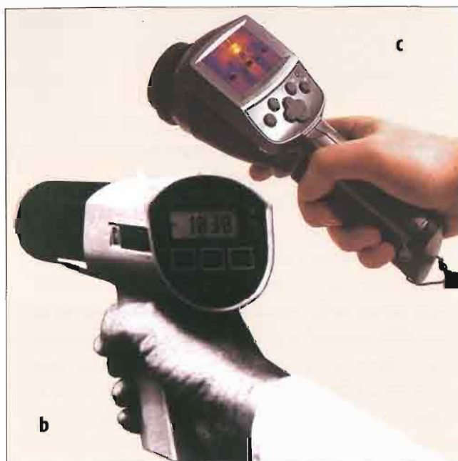
51 Termometri za mjerenje temperature zida: a) mjerenje temperature freske kontaktnim termometrom, b) digitalni infracrveni termometar za daljinsko mjerenje, c) suvremena, prijenosna termovizijska kamera za daljinsko mjerenje temperature zida i dobivanje termovizijske slike
