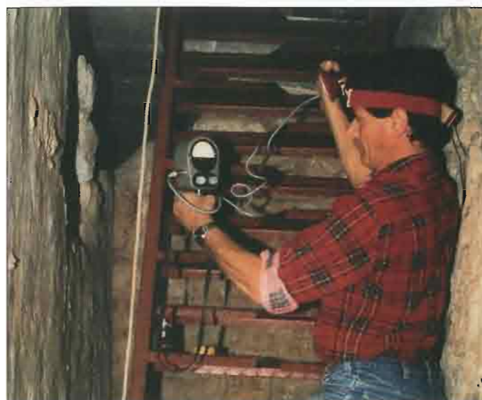
56 Mjerenje brzine strujanja zraka s pomoću anemometra sa žarnom niti (dubrovačka katedrala)
